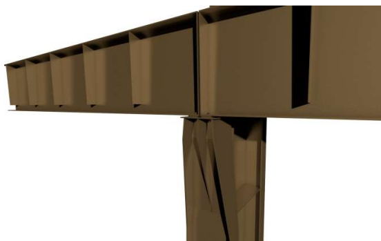
Fig.10.1 Rezemarea grinzii de rulare pe consola stâlpului
